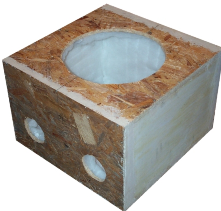
obr. 18 – reprobedna subwooferu bez potaženého koberce, zakytované hrany a vytlumení z vatelínu
