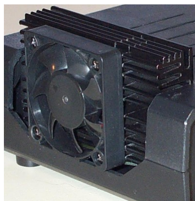
Obr. 15 – zapuštění chladiče do krabčky
