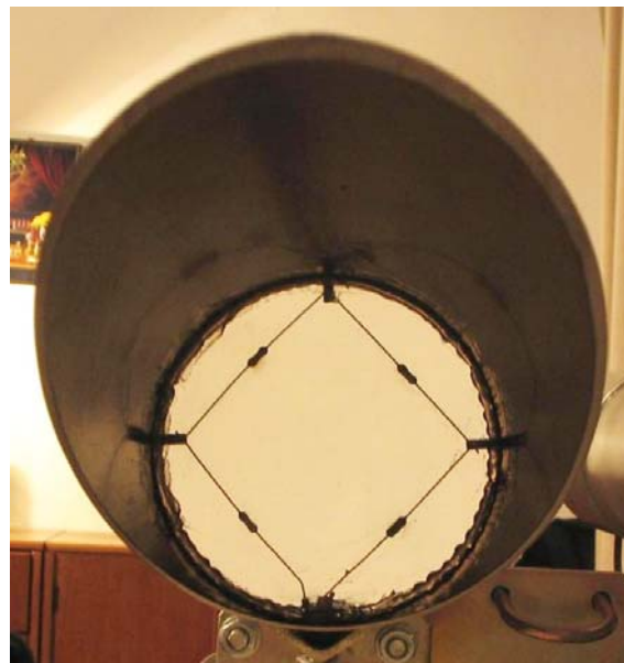
obr. 23 – Rozmístění vyhřívacích rezistorů na čočce
