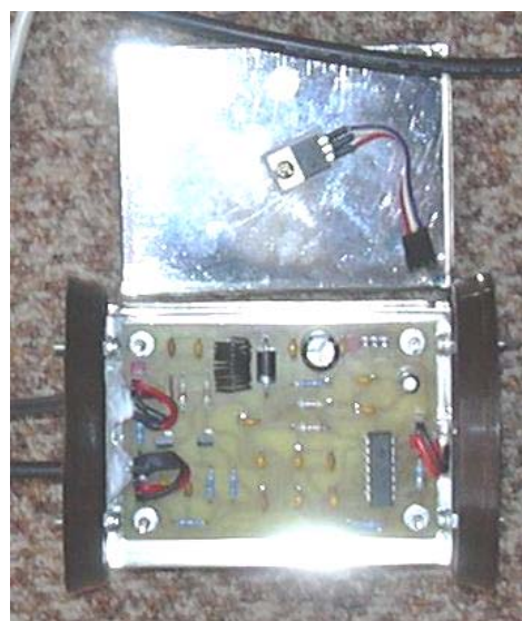
obr. 43 – Vnitřní uspořádání vysílače
