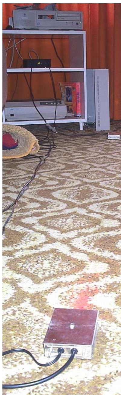
obr. 51 – Testování přenosu dat na co největší vzdálenost bez čoček
