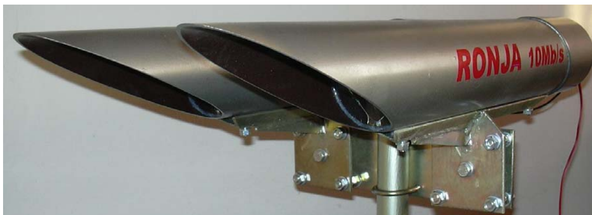
obr. 33 – Roury s čočkami pro vysílač a přijímač
